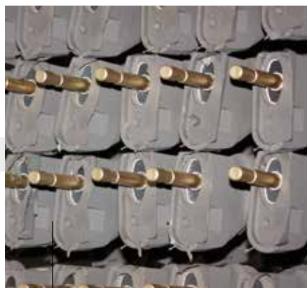
Particolare di prodotti schiumati con inserti in metallo Detail of products with metal inserts obtained by foaming process
